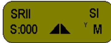
Este display nos indica en su línea superior el tipo de cámara controlado (en este caso **SR II**) y el tipo de compensación (velocidad-diafragma [speed-iris], **SI**).
