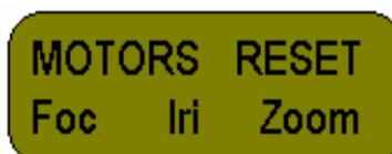
**Iris y Zoom).** Al presionar uno de estos botones, el motor correspondiente a esa óptica girará hacia un lado hasta encontrar el tope mecánico del sistema y a continuación girará hacia el otro lado hasta encontrar el otro tope.
